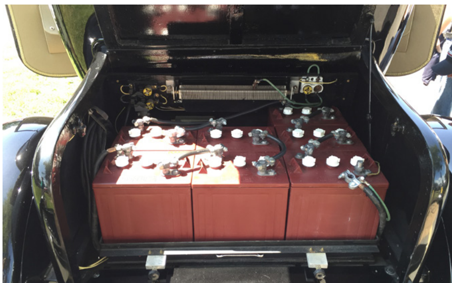
Akumulatory w późniejszej wersji Detroit Electric. Źródło: Christopher Ziemnowicz, https://commons.wikimedia.org/wiki/File:1932_Detroit_Electric_Model_97_-_first_of_7_built_-_at_2015_Macungie_show_3.jpg (30.11.2024), https://creativecommons.org/licenses/by/4.0/
